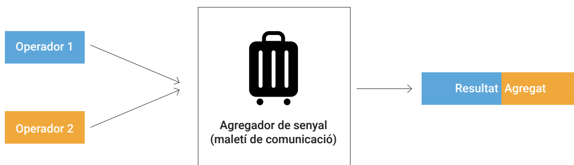
Figura 13: Diagrama explicatiu del bonding; l'agregació de senyals i amplex de banda de dos operadors
