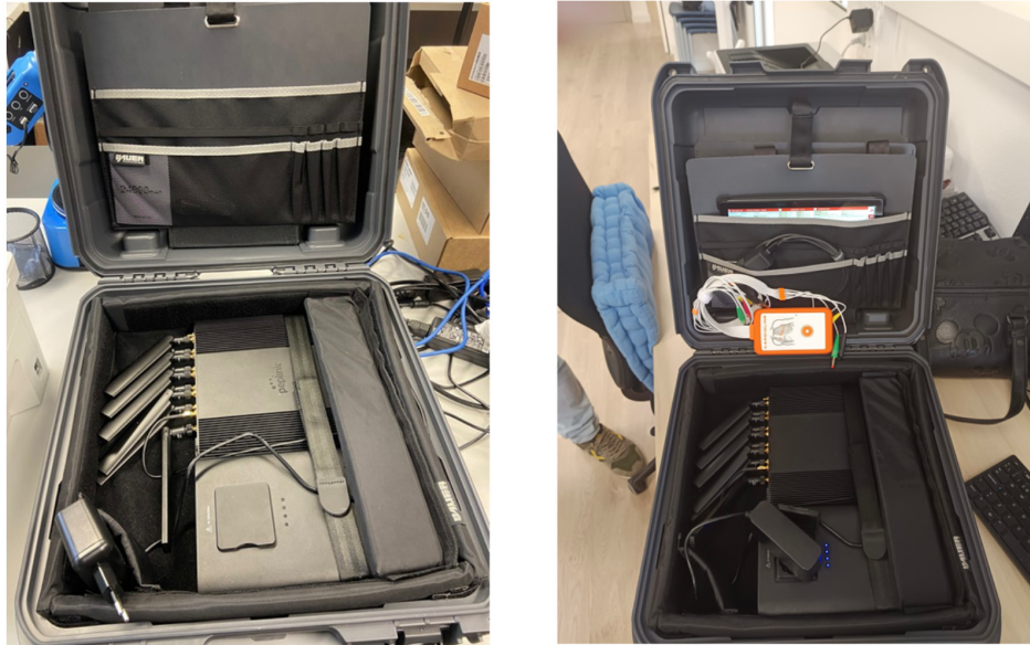
Figura 14: Maleta de comunicacions amb disseny de trolley i amb el ECG i la tauleta tàctil.
